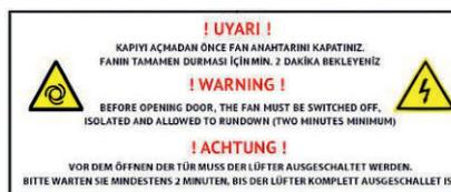
Dieser Warnhinweis befindet sich auf dem Ventilatorbereich der Serviceklappe. Vor dem Öffnen des HepaBoosters muss bei abgeschalteter Spannungsversorgung mindestens zwei Minuten gewartet werden, bevor die Zugangsklappe geöffnet wird.
