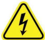
Diese Aufkleber weisen darauf hin, dass sich hinter der Zugangsabdeckung, dem Deckel oder der Blende stromführende Teile befinden, die für den Benutzer / Installateur gefährlich sein können. Nur qualifiziertes Personal, das die örtlichen Normen erfüllt, darf an diesen Teilen arbeiten. Diese Aufkleber befinden sich auf dem Zugangsbereich zum Lüfter der Serviceklappe.
