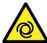
Diese Abbildung zeigt, dass sich hinter der Zugangsabdeckung eine rotierende Maschinenbaugruppe befindet, die Verletzungen verursachen kann.
