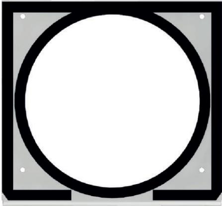
**10. Anbringen des Quellbandes** auf der Rückseite des Unterteils der Wetterschutzhaube (Ausgleich zwischen Wand und Unterteil). Im Unteren Bereich ist mittig ein Abstand von ca. 60 mm freizulassen. Das innere und das äußere Quellband dürfen sich in diesem Bereich nicht berühren!
