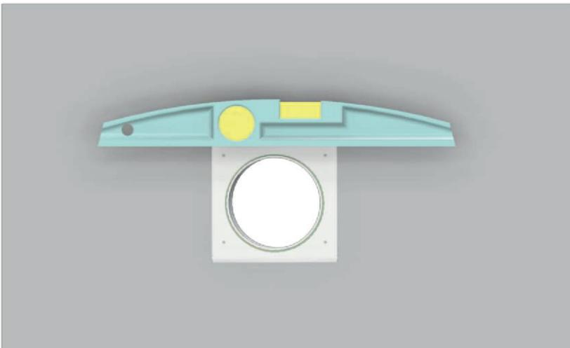
**11. Waagerechtes Anbringen** des Unterteils an der Fassade (Abtropfkante nach unten außen). Dazu das Unterteil auf das überstehende Fixrohr setzen, mit Wasserwaage ausrichten, Bohrungen anzeichnen und mit den Wandaufbau geeigneten Dübeln und Schrauben befestigen.
