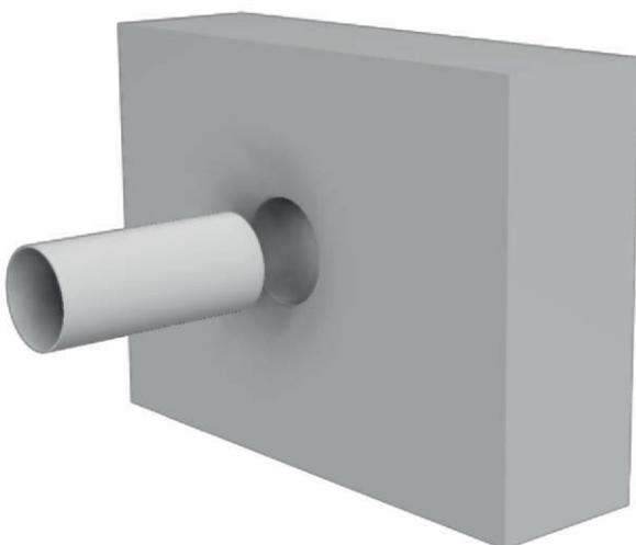
**1. Herstellen des Wanddurchbruchs** mittels Kernbohrung, mindestens 165-170 mm (180 mm bei anschließenden Putzarbeiten möglich).
